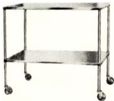
M-303 - Mesa Auxiliar. Tapo superior e estante en acero inoxidable. Estructura en tubo 1". Rodeznos 2". Dimensiones: 0,40x0,40x0,80 M-304 - idem. Dimensiones: 0,40x0,60x0,80 M-305 - idem. Dimensiones: 0,40x0,80x0,80 altura.
