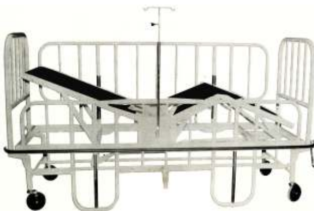
M-208 - Cama de Recuperación con rejas de bajar en ambos lados. Parachoque de protección con goma en vuelta. Cabecera y pezera retirabais. Ruedas especiales de goma con 10". Movimiento Fowler y Trendellenburg por medio de 2 manivelas con pintura epoxi. Dimensiones del lastre: 0,70 X 2,00 X 0,60 de altura. Peso: 86kg.
