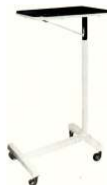
M-315 - Mesa Auxiliar mayo. Tapo superior en acero inoxidable. Ajuste de altura 0,90 a 1,25 cm. Estructura en tubo 30x30. Rodeznos de 2"
