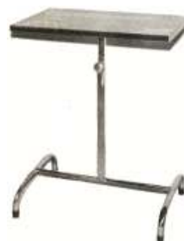
M-338 - Mesa para Quirugia. Armazón en tubo cromada. Tapo superior en acero inoxidable. Ajuste de altura. Dimensiones: 0,40x0,62.
