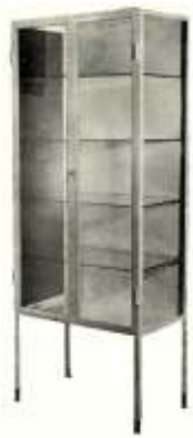
M-102 - Armario escaparate de dos puertas. Frente, lados y 3 estanterías de vidrio. Fondo y techo en chapa pintada en epoxi. Dimensiones: 0,40 x 0,65 x 1,65 de altura.
