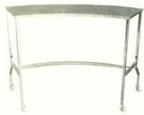
M-312 - Mesa Semi-Circular. Armazón en tubo cuadrado. Tapa en acero inoxidable. Rodeznos de 3". Dimensiones: 1,20 X 0,35 X 0,80.
